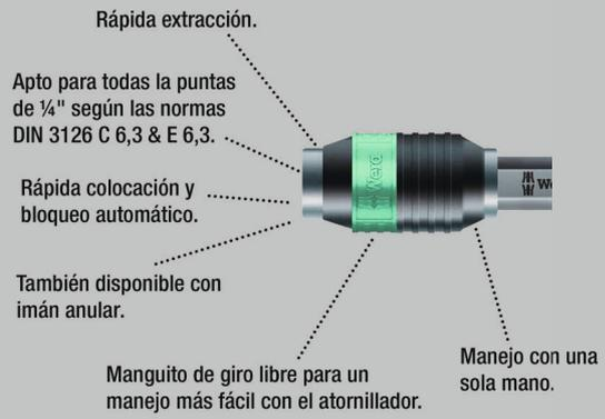
El mango transversal bicomponente de forma ergonómica dispone de cavidades para el apoyo de los dedos y una superficie agradable al tacto lo que permite una alta transmisión de la fuerza y un trabajo sin molestias y fatiga. Para puntas con arrastre hexagonal de  $\frac{1}{4}$ " según DIN ISO 1173-C 6,3 y E 6,3 (ISO 1173). Con tecnología Rapidaptor que permite un cambio superrápido de las puntas.
